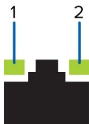
Abbildung 2: (1) Link-LED. (2) Verbindungsaktivitäts-LED.
